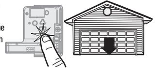
**5** Una vez que la puerta esté en la posición deseada, presione y suelte el botón de Ajuste. Las luces del abrepuertas de garaje parpadearán dos veces y el botón ARRIBA (UP) comenzará a parpadear.
