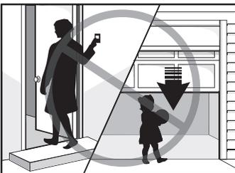
**Mantenga la puerta a la vista hasta que se cierre completamente** cuando utilice el pulsador de pared o el transmisor.
