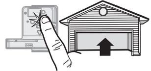
**3** Una vez que la puerta esté en la posición deseada, presione y suelte el botón de Ajuste. Las luces del abrepuertas de garaje parpadearán dos veces y el botón ABAJO (DOWN) comenzará a parpadear.
